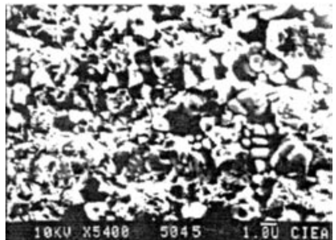
Figura 2. Micro estructura de la cerámica de \text{Pb}_{0.88}\text{La}_{0.08}\text{Ti}_{0.98}\text{Mn}_{0.02}\text{O}_3 .
