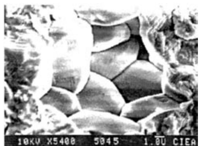
Figura 3 Micro estructura de la cerámica de \text{Pb}_{0.88}\text{Eu}_{0.08}\text{Ti}_{0.98}\text{Mn}_{0.02}\text{O}_3 .
